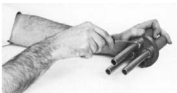
Figure 3. Enlèvement du clip de retenue
