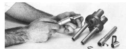
Figure 6. Installation du réducteur dans l'ouverture du contact
