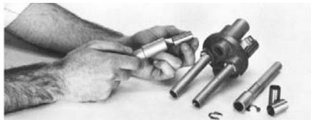
Figure 6. Instalación del reductor de cavidad de cables
