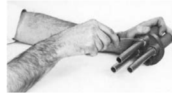
Figure 3. Extracción de la presilla de retención
