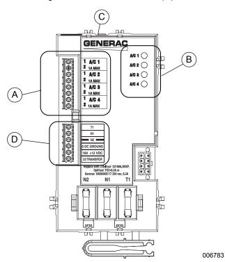
Figure 2-2. Smart A/C Module (SACM)
